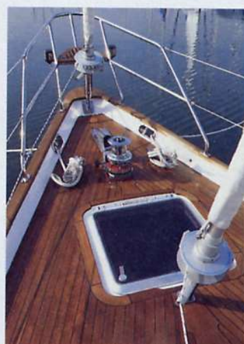
Posta sul dritto di prua, l'ancora non ha più bisogno del musone. Di contro, non può essere sostituita.
