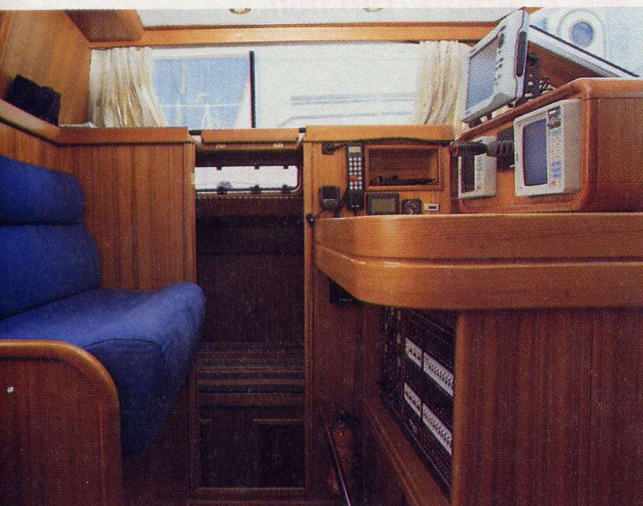
In primo piano, la saletta nautica sopraelevata che include il carteggio con doppia seduta e la consolle portastrumenti; sul fondo si nota il locale equipaggio con cuccetta e wc.
