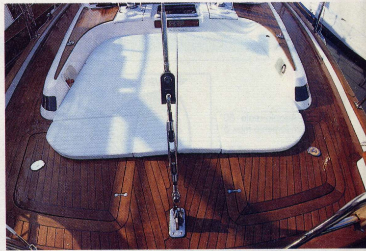
La zona di poppa è completamente piana e ingloba un ampio prendisole in parte raccolto nel prolungamento dei due paraspruzzi. Visibili i due portelli dei gavoni, entrambi molto profondi, a cui si aggiunge la cala vele di prua.
