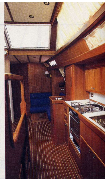
Della cucina a sviluppo lineare colpisce l'altezza sotto il baglio che è 2,40 m. Molto ampio lo stivaggio.
