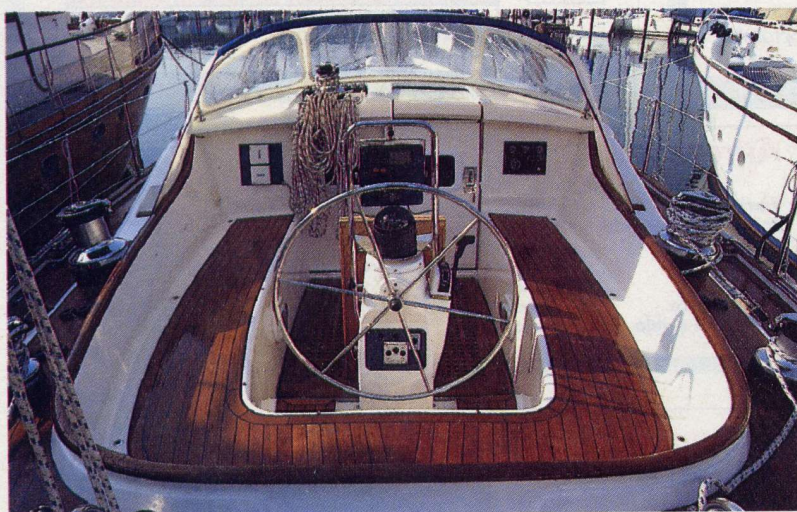
Il pozzetto lungo 2,40 m e largo 2,03 m è protetto dal dodger in tela e dai paraspruzzi continuo, che realizza sedute molto comode, inclusa quella del timoniere che può controllare tutte le manovre di scotta poste a lato.
