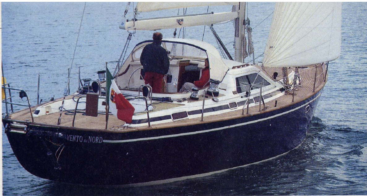
La vista laterale evidenzia le linee classiche che caratterizzano tutta la nuova serie del cantiere e che trovano nel taglio della poppa "vecchio stile", nella insellatura del cavallino e nello slancio accentuato della poppa gli ingredienti principali. L'armo a sloop-cutter, con la randa di importanti dimensioni, consente un facile e sicuro controllo delle superfici.
